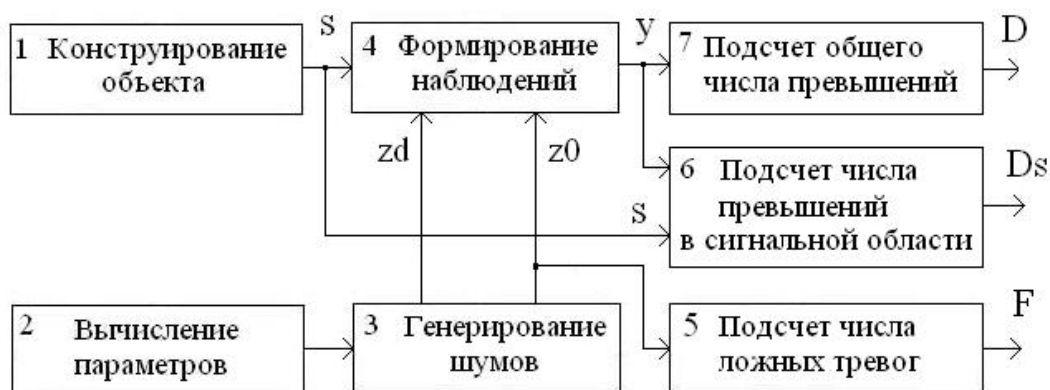
Рис. 1. Общая структура программы моделирования объектов на фоне шумов и алгоритмов обнаружения с постоянным порогом
